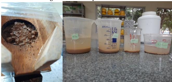
Legenda: A: Amostra do solo após o ensaio; B: Partículas em sedimentação
