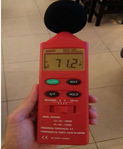
Figura 2: Analisador manual Instrutherm modelo DEC-460, faixa de medição de 35 a 130dB com calibrador interno
