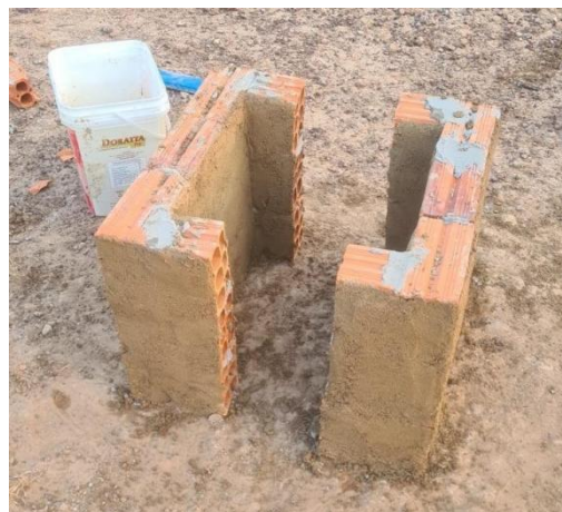
Figura 3: Modelo 3 - Construído com argamassa especial, thermo-x
