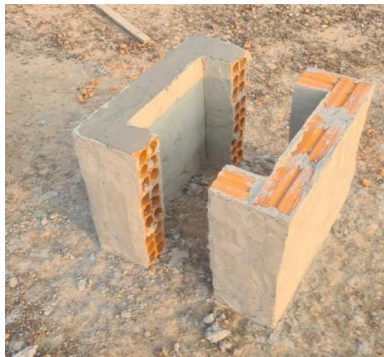
Figura 2: Modelo 2 - Construído com argamassa comum
