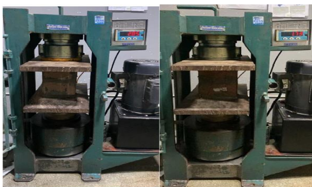
Figura 8: Teste de compressão realizado nos tijolos ecológicos
