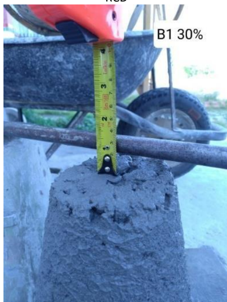
Figura 2 - Abatimento brita 1 com adicional de 30% RCD
