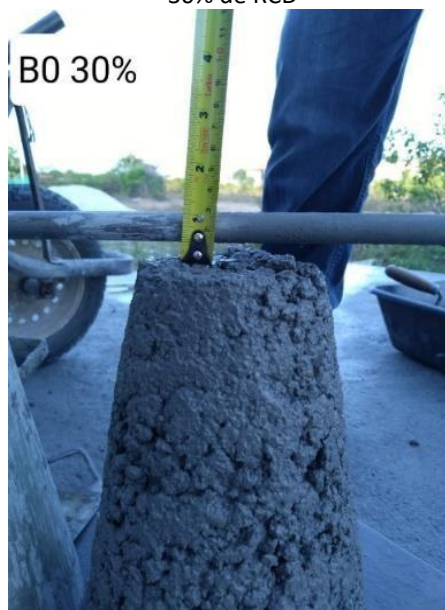
Figura 3 - Abatimento da brita 0 com adicional de 30% de RCD
