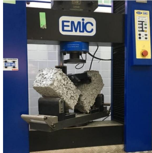
Figura 20: Corpo de prova na prensa
