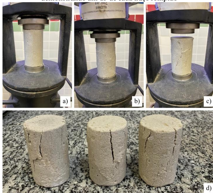
Figura 5 – Ensaio de compressão axial dos corpos de prova (a) no momento inteiro, (b) sob a força máxima, (c) rompido e (d) demonstrando um CP de cada traço rompido
