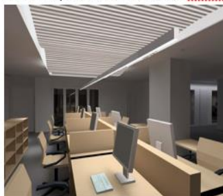
Figura 06 – Análise luminotécnica em escritório produzido no software DIALux
