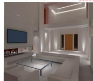
Figura 07 – Análise luminotécnica em sala de estar produzido no software DIALux
