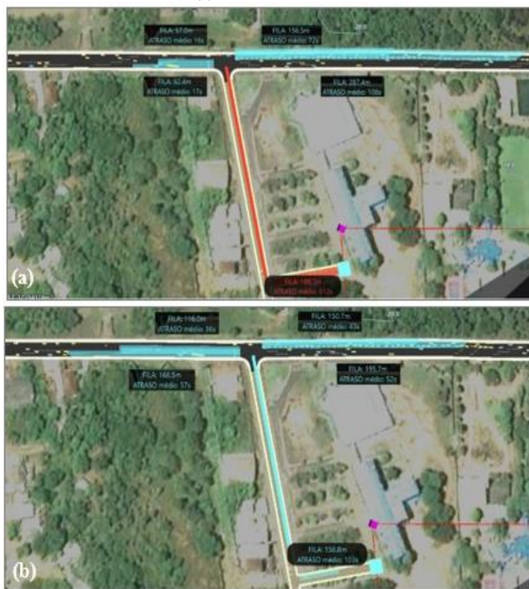
Figura 11 – Representação do comprimento da fila máxima (a) Cenário atual (b) Cenário 12 simulado.
