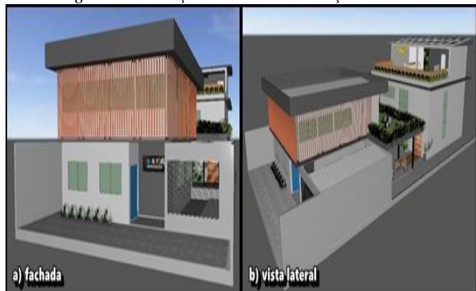
Figura 20– Utilização de Brises na edificação existente
