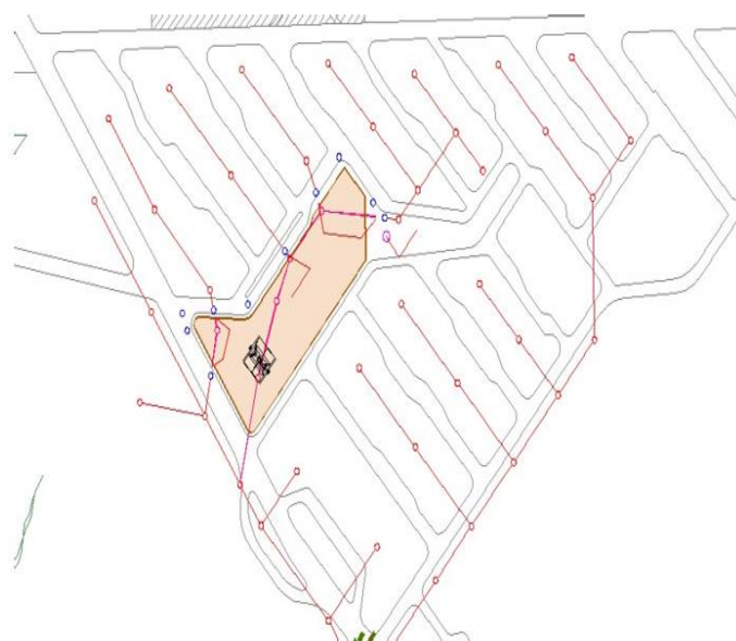
Figura 1 – Aspecto da rede em sistema condominial de esgoto da Vila Amazonas
