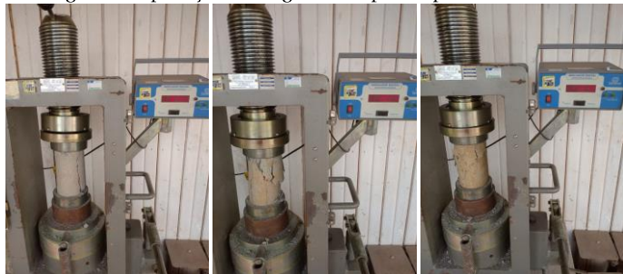
Figura 3 – Aplicação de carga nos corpos de prova em análise
